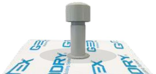
Аэратор диаметром 75 мм и высотой 200 мм методом термической сварки соединён с гидроизоляционной мембраной G-TEX ACTIVE, размером 40 см x 40 см. При наличии паровых испарений, позволяет выводить их наружу. Гарантирует непрерывную гидроизоляцию в гидроизоляционных системах GEODRY.
