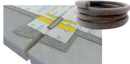
Шнур круглого сечения из вспененного полиэтилена с закрытыми ячейками, для заполнения строительных, компенсационных швов или швов статического происхождения, а также для любых других трещин, щелей или зазоров подлежащих последующей герметизации. Применяется в гидроизоляционных системах GEODRY.
