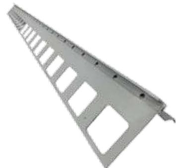
Периметральный алюминиевый профиль, окрашен в серый цвет, для отделки и защиты кромок плитки, уложенной на террасах и балконах, с краем покрытия плитки 12,5 мм. Сечение профиля определяет перфорированный дренажный канал для обеспечения оттока воды. Оснащен специальными частями, такими как наружный уголок 90° и соединительный фитинг.
