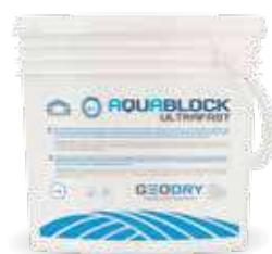
Минеральный связующий состав с характеристиками быстрого схватывания и твердения, используется для блокирования водных протечек. Устойчив к положительному и отрицательному гидравлическому давлению. Начало схватывания 40 секунд. Применяется в гидроизоляционных системах GEODRY.
