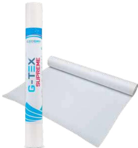
Гидроизоляционная мембрана на основе ТРО-ФРО-ТНТ\С белого цвета, водонепроницаемая, устойчивая к ультрафиолетовому излучению, стойкая к проколам, с контролем диффузии пара, стабильность размеров от -40 °C до +80 °C, стойкая к прорастанию корней и образованию плесени, используется для создания открытой гидроизоляции на поверхностях любого типа и размера. Полотна мембранны герметизируются методом термической сварки.
