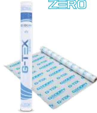
Нетканый микропористый, водоотталкивающий, воздухопроницаемый, полипропиленовый, эластичный текстиль «ткань без ткани», устойчив к щёлочам. Используется как промежуточный материал в системах AQUARESET (A+B) или GEOLASTIC (A+B), а также в эластомерных гидроизоляционных системах, гарантирует эластичную гидроизоляцию, полное покрытие и преодоление трещин. Хранить продукт вдали от ультрафиолетовых лучей.
