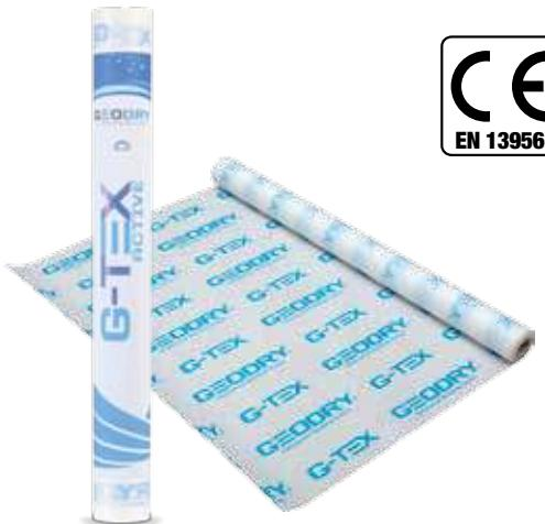
Гидроизоляционная мембрана на основе FPO-термопластичного полиолефина, водонепроницаемая, разъединяющая, эластичная, гибкая, деформируемая, имеет способность покрытия и преодоления трещин, стабильность размеров от -40 °C до +80 °C, используется для реализации гидроизоляции и разъединения перед укладкой отделки из керамики, керамогранита, стеклянной и керамической мозаики, стекла, натурального и реконструированного камня, упругих, защитных и декоративных материалов.
