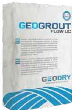
Минеральный состав наливного типа с компенсированной усадкой, низким модулем эластичности, армирован волокнами, с высокой механической прочностью, для смешивания с добавкой UC, используется для восстановления и структурной консолидации с гарантированной прочностью поврежденных бетонных конструкций при температурах до  $-20^{\circ}\text{C}$ . Применяется в восстановительных системах GEODRY.
