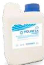
Пропиточная грунтовка на основе полиуретановых смол в водной дисперсии, для предварительной обработки стыковых соединений между гидроизоляционной мембраной G-TEX AIRFULL и сопутствующими аксессуарами, перед применением адгезива AQUAFIX ULTRA A+B. Для специального использования при реализации гидроизоляции резервуаров, бассейнов или сооружений в постоянном контакте с водой.
