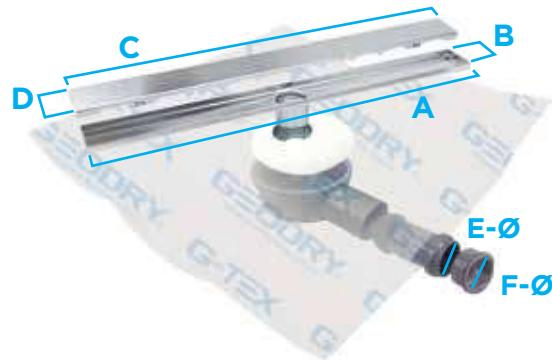
Комплект для гидроизоляции душевых напольных поверхностей, имеет боковое выпускное отверстие в виде сифона на основе полипропилена, корпус решётки из нержавеющей стали и гидроизоляционную мембрану G-TEX ACTIVE размером 120 см x 200 см, которая зафиксирована методом термической сварки. Выпускное отверстие расположено на расстоянии 40 см от края короткой стороны мембранны. **Отделка решётки: INOX - нержавеющая сталь или керамическая плитка.**
